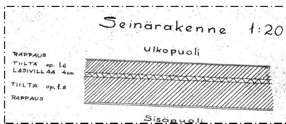
Kuva 22. Rakennuksen ulkoseinärakenne US1
